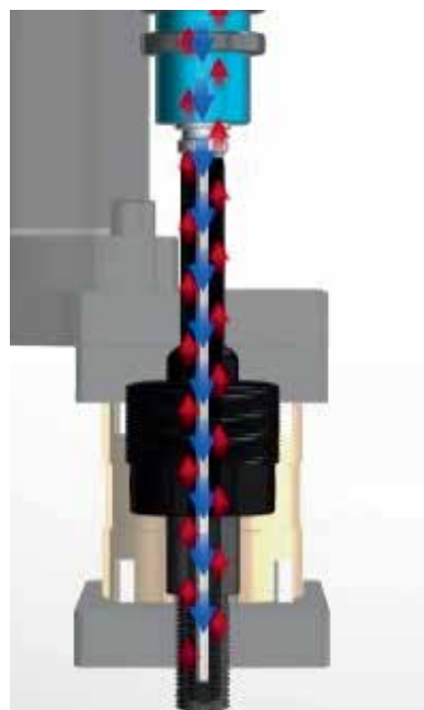
Funktion Kernkühlung Beispiel Gewindeausschraubeinheit
